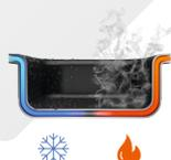
Mehrschichtmaterial mit einem Aluminiumkern zwischen zwei Edelstahlschichten, vereint die hygienischen Edelstahl-Vorteile mit den thermischen Aluminium-Vorteilen.
