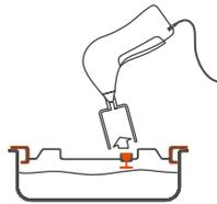
Pumpe lösen, vaculid® Plug hält das Vakuum.
